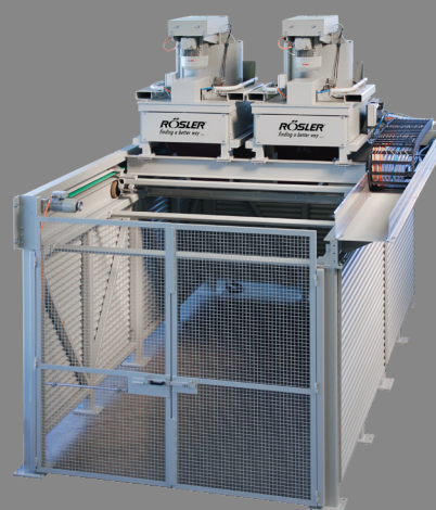
2 x RZ 150 A con base rimuovibile; fango scaricato in contenitore
